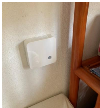
Figure 39 – Illustration de la mise en place d'un capteur utilisé pour les mesures de température, humidité relative, taux de CO 2 et éclairage intérieurs parmi les logements instrumentés
